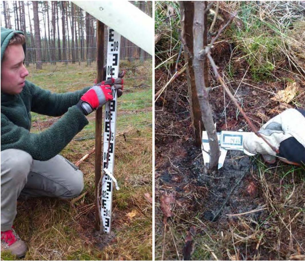
Abb. 5: Längenmessung und Messung des Wurzelhalsdurchmessers
